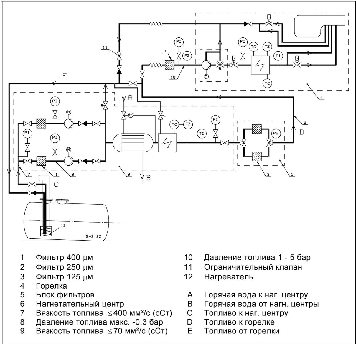
Производительность нагнетательного центра должна быть на 200 кг/ч выше сжигаемого количества топлива. Например, при производительности горелки 200 кг/ч => требуемая производительность нагнетательного центра ок. 400 кг/ч.
