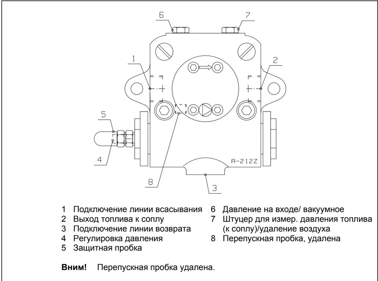
Максимальное давление и температура топлива на входе в насос: 5 бар +140 °С.
