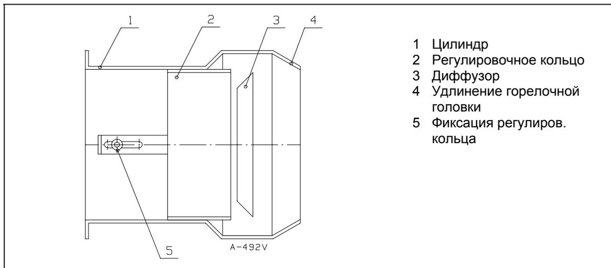
**Вним!** Если место кольца относительно диффузора меняется, также скорость и расход воздуха меняются. Проверьте результат сжигания анализом дымовых газов и подрегулируйте подачу воздуха.
